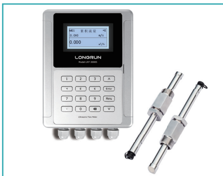
插入式超声波流量计: LRF-3000S-TT05 (适用温度: -40^{\circ}\text{C} \sim +130^{\circ}\text{C} ) (适用管径: DN50-DN1200)
