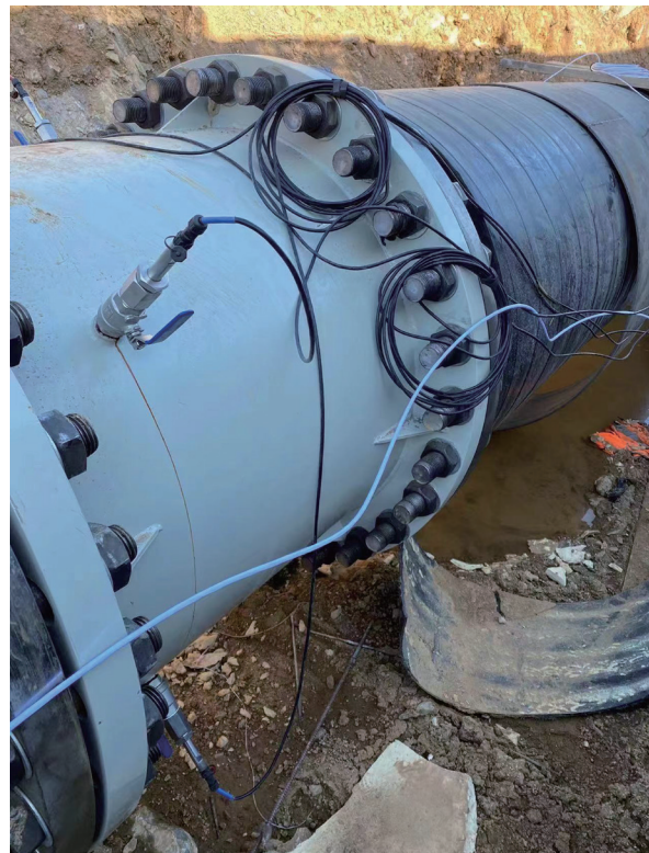
环保、污水等插入式超声波流量计应用
